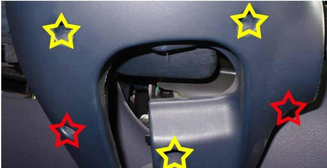
attention à bien repérer la taille des vis, les encadrées jaunes sont plus longues..., la descendre ensuite en faisant attention à ne pas abimer l'antenne réceptrice de l'anti démarrage autour du neiman et à n pas accrocher de câbles du faisceau.
