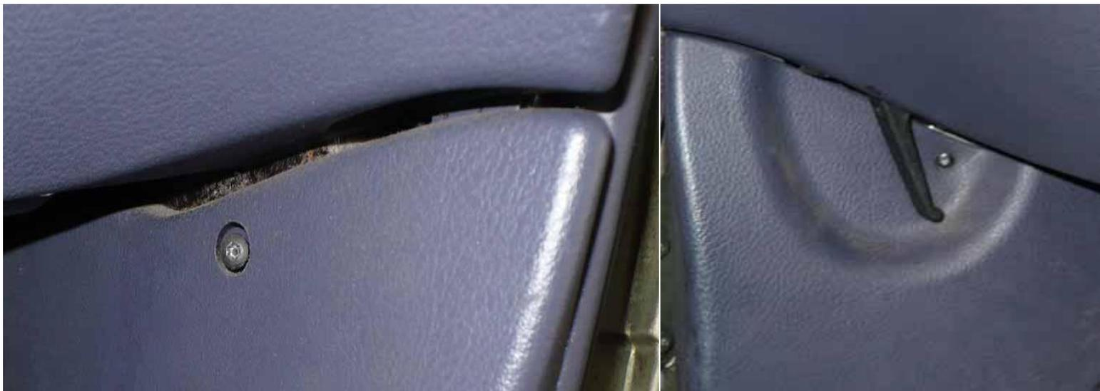
Une fois les pièces retirées, quand cela est possible, remettez les vis dans leurs trous de fixations, cela simplifiera le remontage (quelle type de vis va où )
