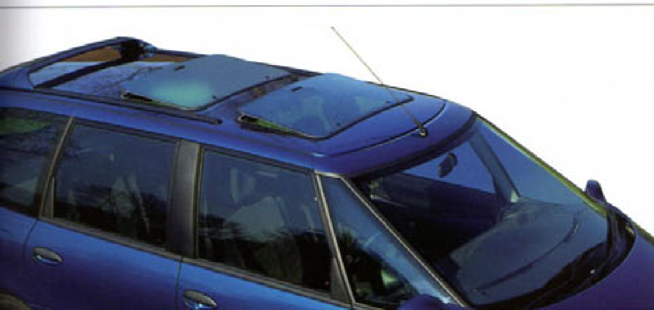
3-11. Toit ouvrant entrebâillant 1992 1996 Issu de l'option série, ouverture manuelle par manivelle, vitre mercurisée verte, stores pare-soleil intégrés. Se monte aux 3 emplacements. 60 25 370 910
