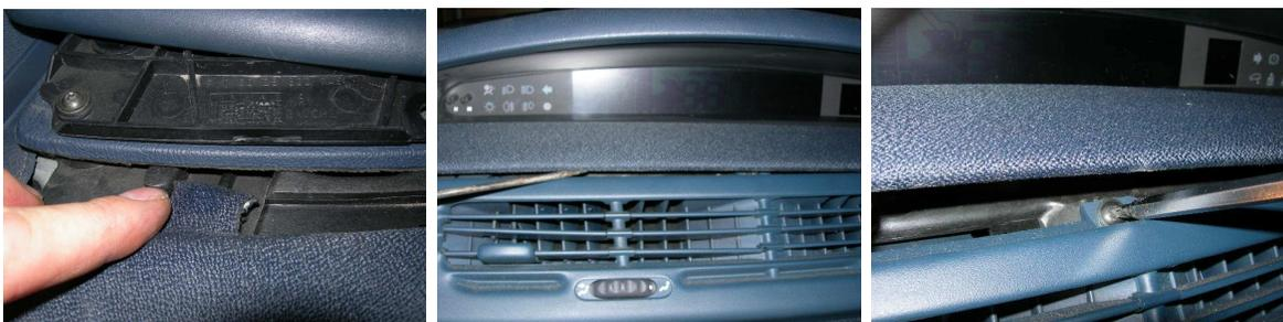
Pensez à la patte du bandeau à remettre sous le HP au remontage. Enlevez la vis au centre et les 2 griffes pour déposer l'aérateur central ;
