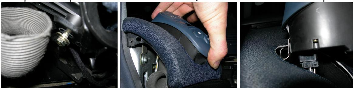
Déposez la grille du haut parleur gauche (elle se déboîte en la tirant vers le haut) et déposez partiellement la partie gauche du bandeau tissus du tableau de bord en forçant légèrement au centre pour le déboîter à huit ou neuf endroits ;
