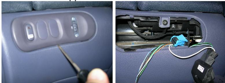
Si vous arrivez à enlever la vis qui maintient la commande de clim en passant par cette ouverture, **bravo** ; déposez la commande et passez directement à la dépose du bandeau tissus du tableau de bord
