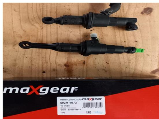
Les futs des deux émetteurs sont quasi identiques , seul change l'orientation des sorties d'huile et la longueur des tiges d'attache sur la pédale d'embrayage . Donc quelques modifications a faire .
