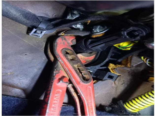
Maintenant que l'émetteur est en place et bloqué , il faut adapter le point d'attache sur la pédale d'embrayage .
