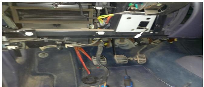
Après avoir dégrafé la tige de l'émetteur de la pédale d'embrayage avec un tournevis plat utilisez une pince pour débloquer l'émetteur en le tournant d'un huitième de tour .
