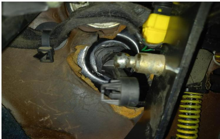
Il faut couper avec une scie à métaux le teton de la pédale qui ne sert plus à rien puisque la pièce d'origine est introuvable et qu'il faut adapter un autre point d'attache .
